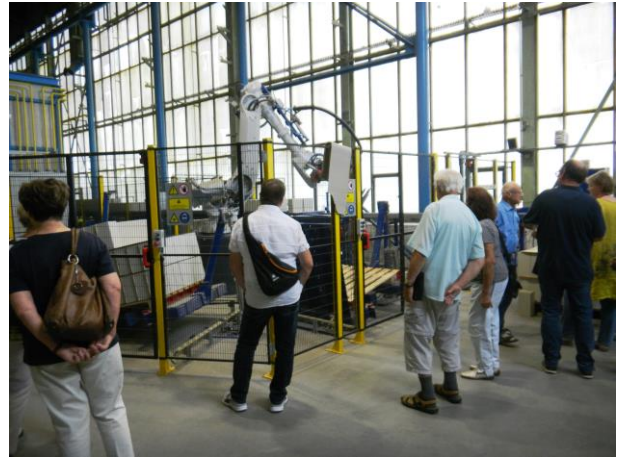
Industrieroboter von ABB zur Reinigung und Sortierung der gebrannten Ware und Abstapelung auf die Palette.
