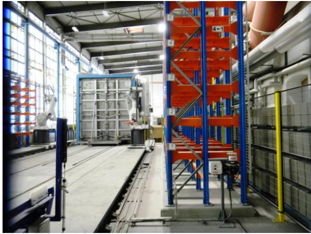
Herdwagenofen mit Hochregallager und Roboter (Hintergrund links) zur Bedienung der Lager und Be- und Entladung des Ofenwagens.
